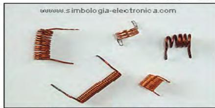
Bobinas con núcleo de aire
