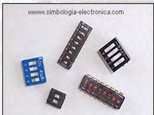
Microinterruptores, montaje DIP
