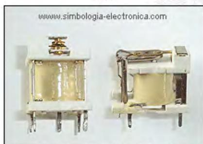
Bobina y contacto de un Relé
