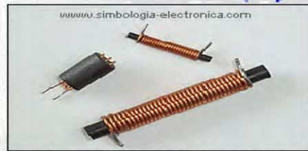
Bobinas con núcleo de ferrita
