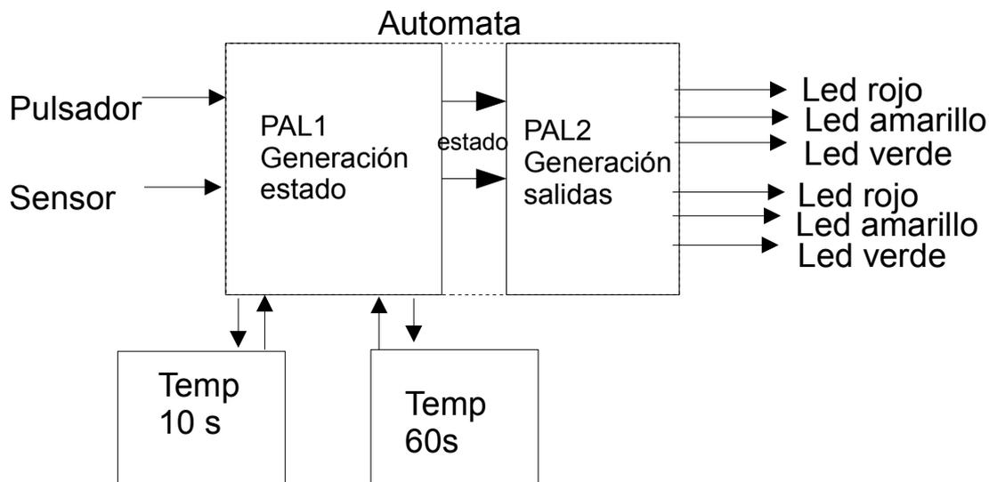
Para la realización dispondremos de un reloj de 1s (habrá que diseñarlo a partir de un aestable). Cada temporizador se realizará con una PAL16V8. El autómata (que será de MOORE) se realizará con dos PAL16V8, una de ellas (secuencial) servirá para generar el estado, se programará mediante diagrama de estados o bien tabla registrada, la otra (combinacional) generará la salida a partir del estado, se programará mediante una tabla combinacional.
