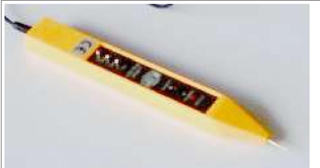
Fig. 3. Inyector lógico K&H LP-540H
