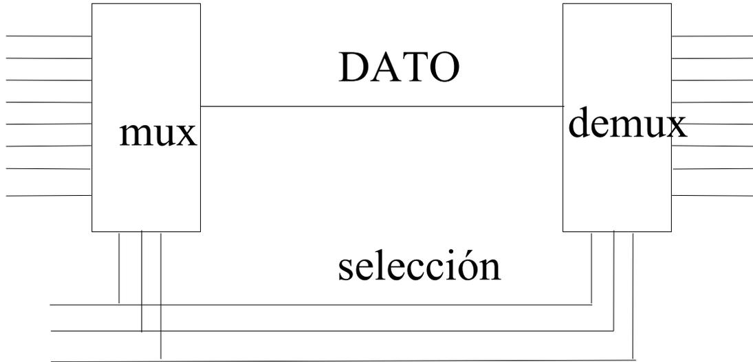
Montar el sistema en un entrenador con multiplexores y demultiplexores comerciales, y la circuitería adicional necesaria para que los datos lleguen al destino igual que salen del origen. Probar el funcionamiento del sistema en el entrenador.
